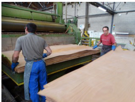
...à la fabrication du contreplaqué à partir de bois de peuplier, © A. Robert, 2018
