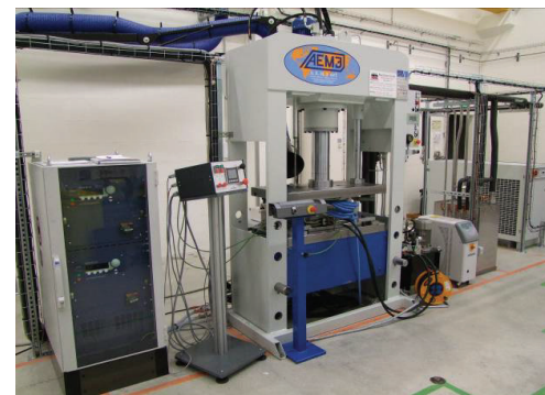
Presse avec chauffage inductif
