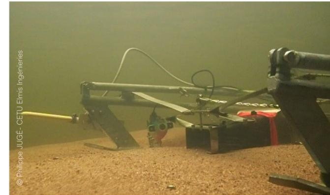
Échantillonneur de charge de fond (BTMA - *Bedload Transport Meter Arnhem*) en position de mesure dans le chenal principal de la Loire.
